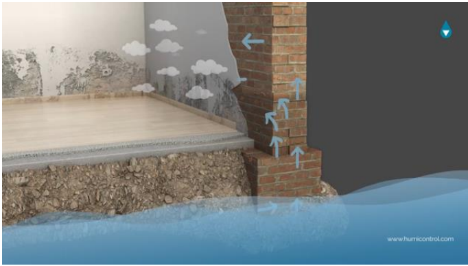
Abb. aufsteigende Wassermoleküle bzw Feuchtigkeit
